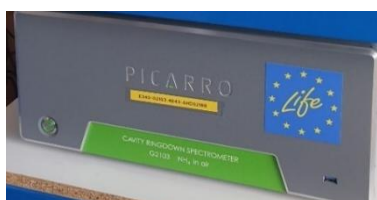
Figure 3 : Analyseur de mesure du \text{NH}_3 en continu installé à Rocabey
