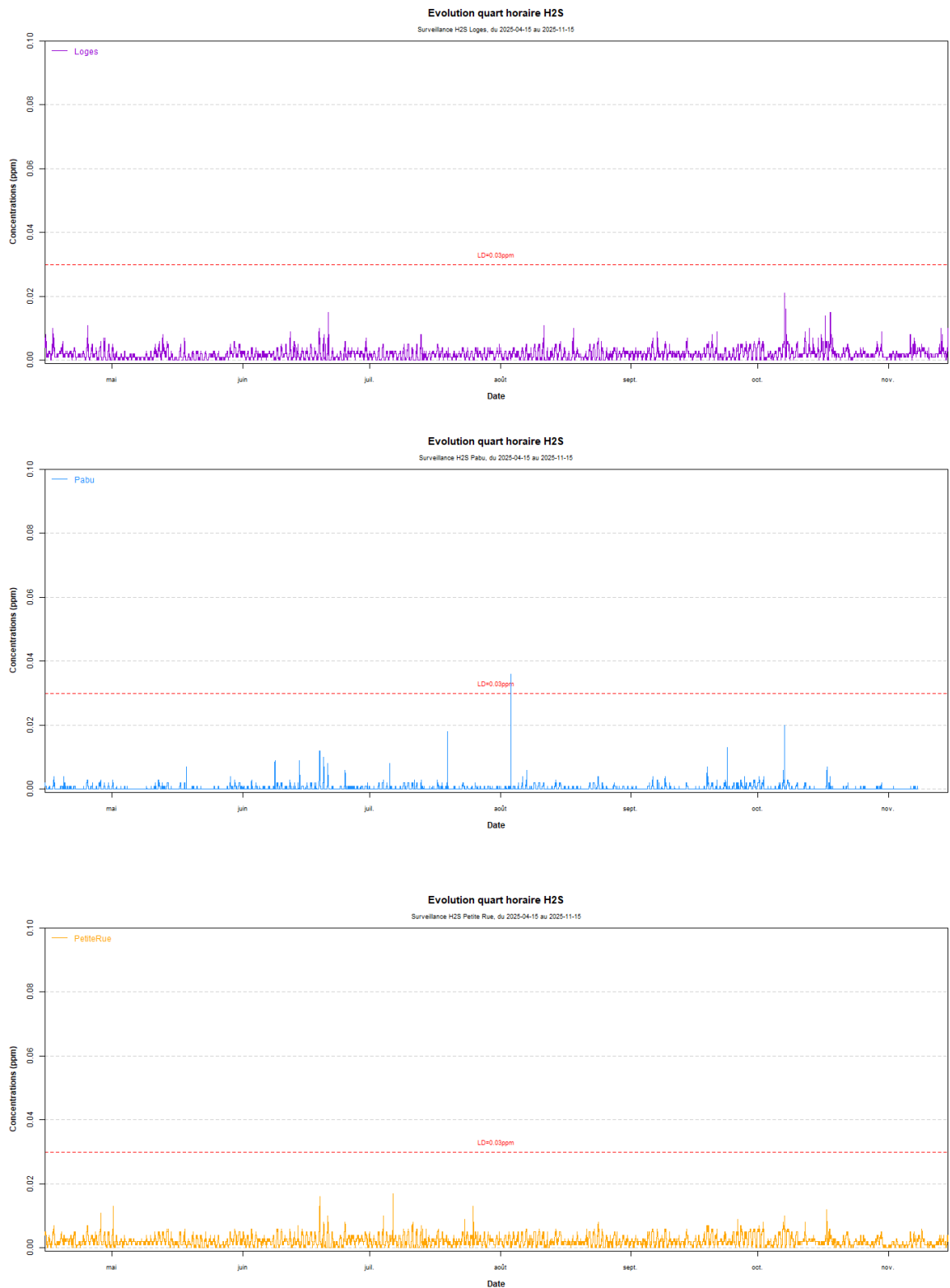
Figure 19 : Evolution des données quart-horaires en H 2 S sur les sites riverains (en ppm)
