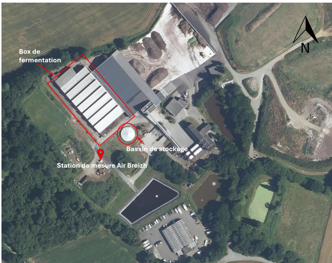
Figure 12 : Positionnement de l'analyseur sur le site et des sources d'émissions d'H 2 S
