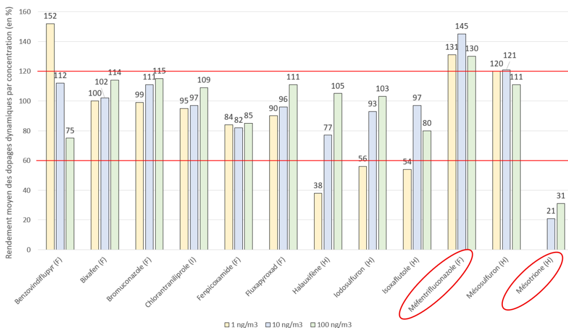
Figure 7 : Capacité de rétention des 23 substances sélectionnées
