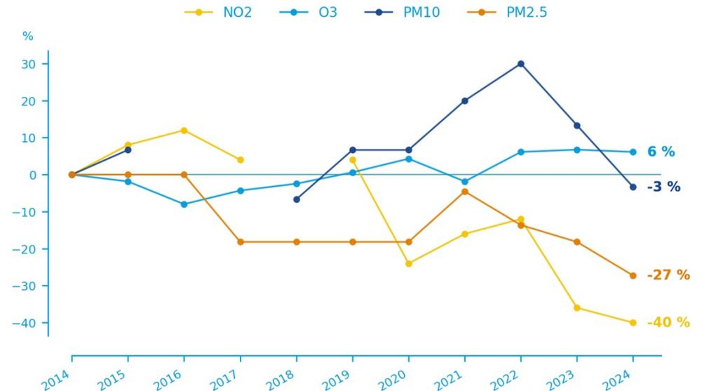
L'évolution des moyennes annuelles depuis 10 ans pour les polluants réglementés montre une diminution globale des concentrations mesurées dans l'air, tant pour le dioxyde d'azote (NO<sub>2</sub>) que pour les particules fines (PM2.5).
