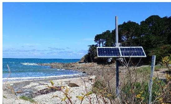
Capteur H<sub>2</sub>S sur l'un des points de mesure
