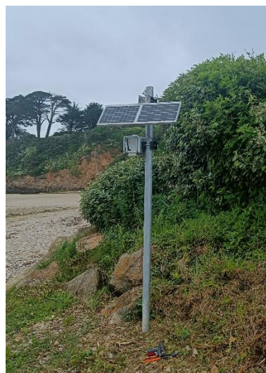
Figure 2 : Capteur de mesure indicative (ENVEA) sur un site de mesure
