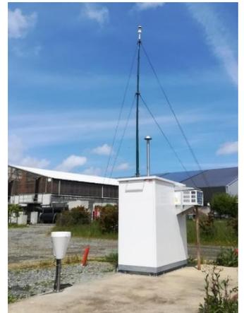
Figure 8 : Station de mesure installée sur le site de Lantic avec mât météorologique et pluviomètre.
