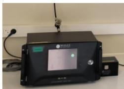
Figure 2 : Aéthalomètre à la station Thabor à Rennes
