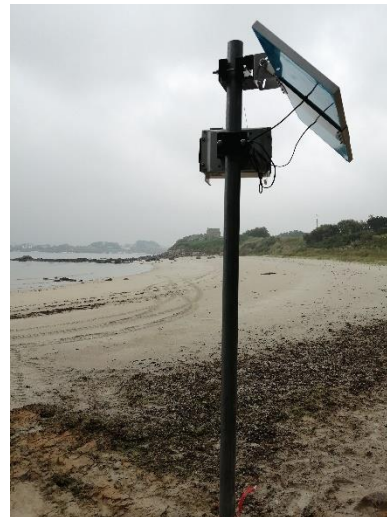
Figure 2 : Capteur de mesure indicative (ENVEA) sur un site de mesure
