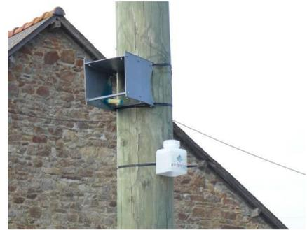
Figure 4 : Tube à diffusion passive sous abri
