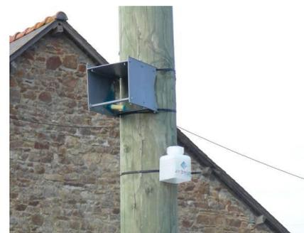
Figure 3 : Tube à diffusion passive sous abri
