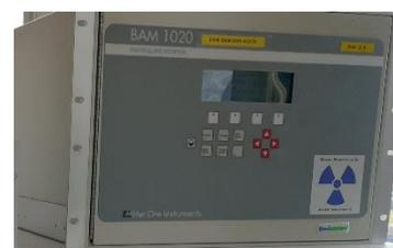
Figure 4 : Analyseur de particules BAM à Rocabey
