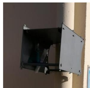
Figure 6 : Boîte contenant un tube à diffusion passive
