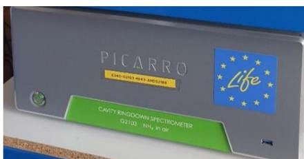
Figure 7 : Analyseur de mesure du NH<sub>3</sub> en continu installé à Rocabey
