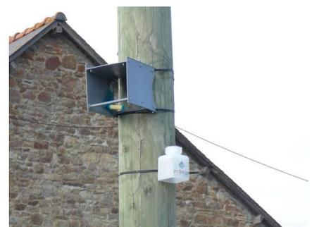
Figure 9 : Tube à diffusion passive sous abri
