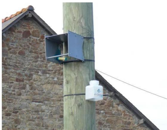
Figure 4 : Tube à diffusion passive sous abri
