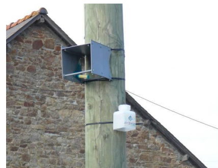
Figure 4 : Tube à diffusion passive sous abri
