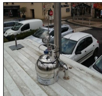
Figure 5 : canister utilisé pendant la campagne de mesure des COVNM
