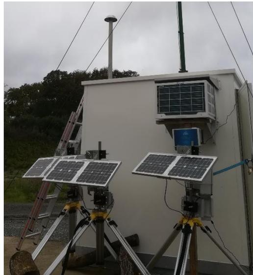
Figure 4 : Contrôle métrologique des capteurs au niveau de la station de mesure sur le site de Lantic
