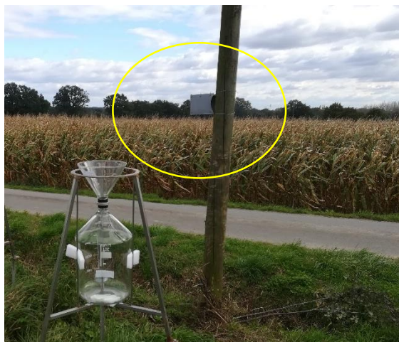
Figure 10 : Boîte contenant un tube à diffusion passive
