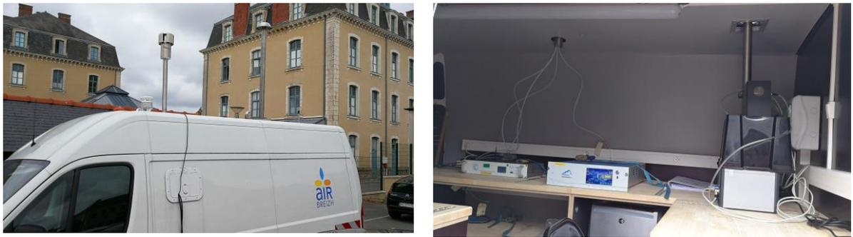
Figure 5 : Dispositif de mesure réglementaire mis en place pour la campagne (à gauche : camion laboratoire et à droite : équipements de mesure)
