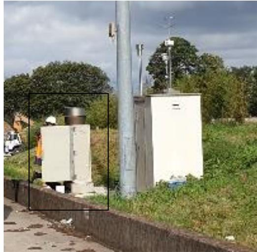
Figure 12 : Analyseur temps réel des particules sédimentables
