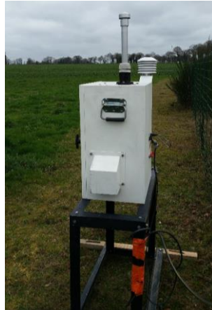
Figure 40 : Préleveur bas volume Partisol utilisé pour le prélèvement des pesticides dans l'air
