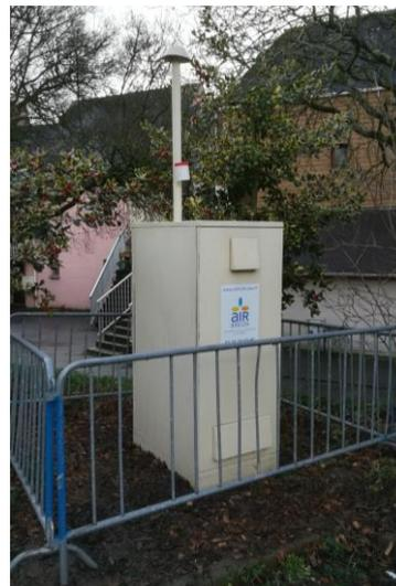
Figure 6 : Cabine contenant l'analyseur de mesure des NO<sub>x</sub> en continu
