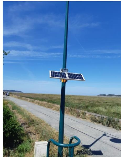
Figure 4 : Capteur de mesure indicative (ENVEA)
