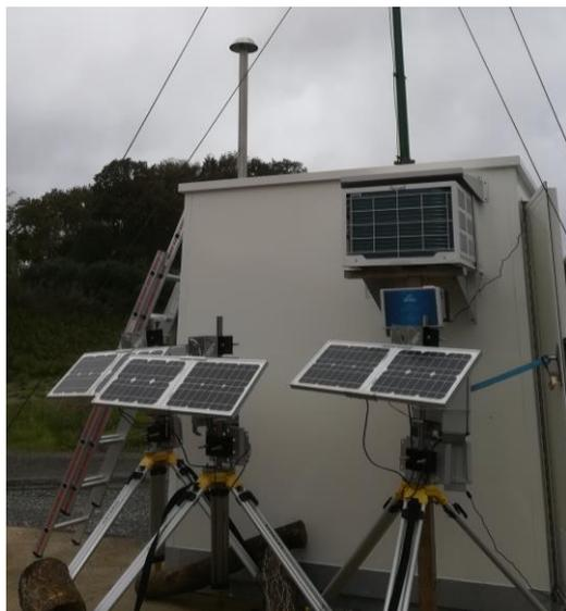
Figure 5 : Contrôle métrologique des capteurs au niveau de la station de mesure du site de traitement des déchets de Lantic (22)
