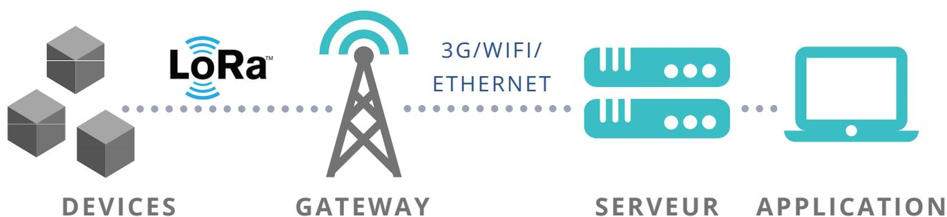
Figure 13 - Architecture d'un réseau LoRaWAN
