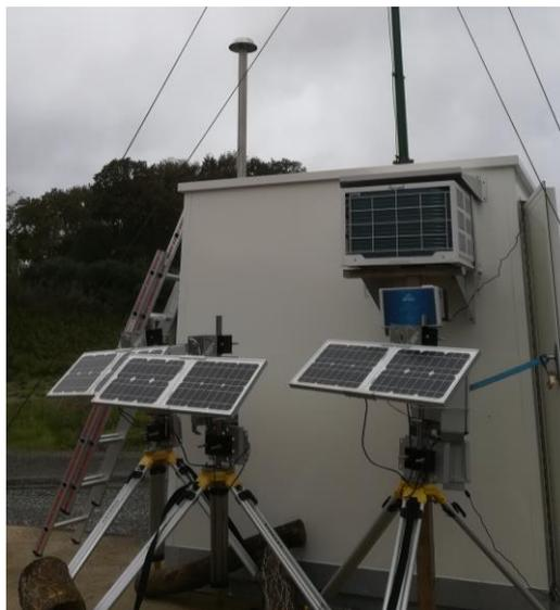
Figure 4 : Contrôle métrologique des capteurs au niveau de la station de mesure sur le site de traitement des déchets
