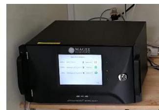
L'analyseur de carbone suie à Pays-Bas est un aéthalomètre.
