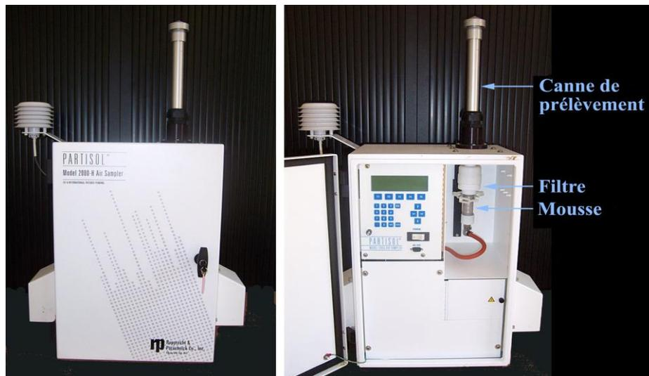
*Système utilisé pour prélever les pesticides dans l'air*
