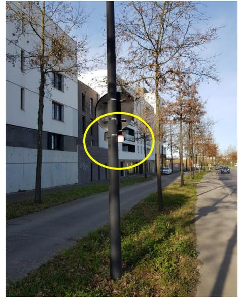
Figure 8: Exemple de points de prélèvement avec tube passif sur l'avenue Roger Dodin (Point 6)
