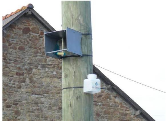
Figure 5 : Boîte contenant un tube à diffusion passive
