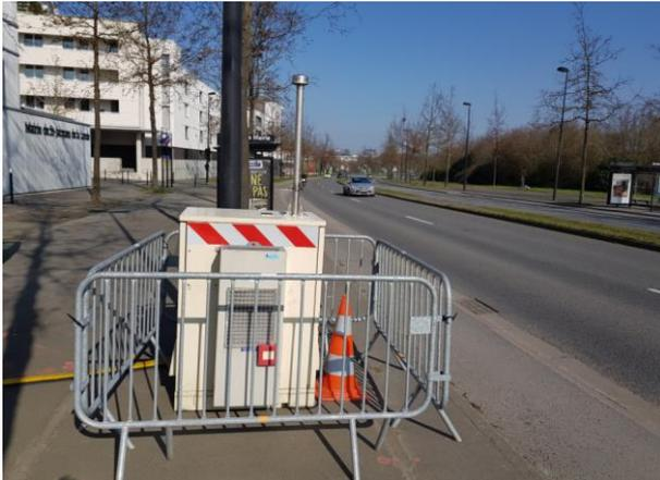
Figure 7: Dispositif de mesure en continu sur le secteur avenue Roger Dodin
