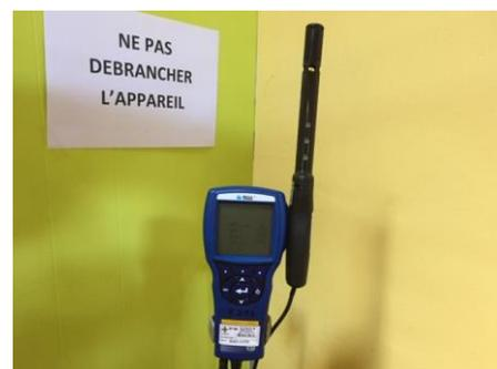
Prélèvements en CO<sub>2</sub> et paramètres de confort
