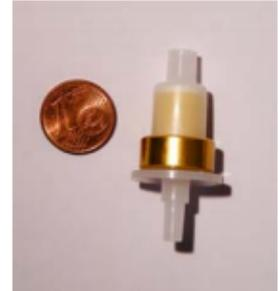
Le piégeage des aldéhydes est basé sur le principe de la chimisorption et passe par la réaction de la DNPH, qui imprègne un support solide (silice, fluorosil...), avec les composés carbonyles pour former des hydrazones, comme le montre la figure suivante :
