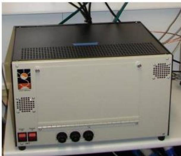
L'appareil se présente en un seul module à l'intérieur duquel l'air ambiant est aspiré pour passer au travers du filtre en quartz qui se trouve dans le four.
