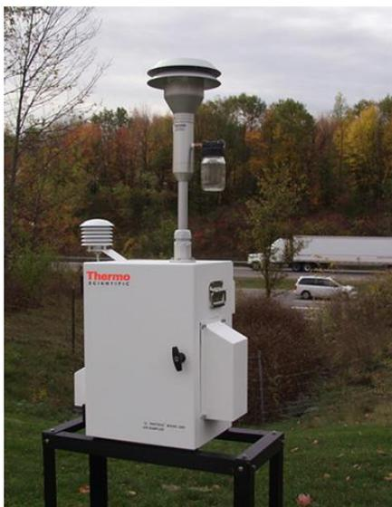
Le Partisol est un échantillonneur d'air pouvant aussi bien être installé à l'extérieur, dans l'environnement, qu'à l'intérieur des locaux. L'aspiration de l'air est assurée par une pompe à vide interne. La régulation du débit d'aspiration est assurée par un régulateur électronique du débit de volume afin de faire fonctionner les têtes de prélèvements à leur débit nominal, indépendamment des conditions de prélèvements (température, altitude).
