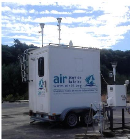
Figure 13 : Unité mobile installée sur l'un des points hors site
