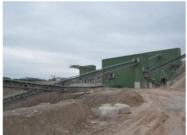
Figure 5 : Convoyeurs utilisés pour le déplacement des matériaux vers les installations de traitement 2<sup>aire</sup> et 3<sup>aire</sup>
