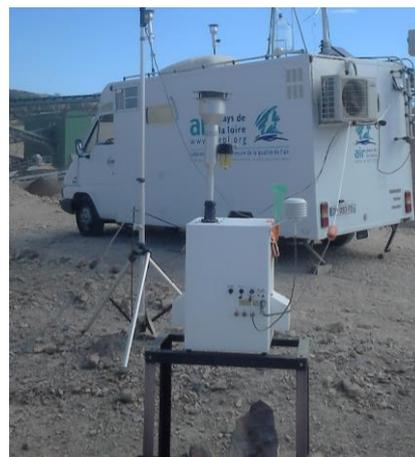
Figure 15 : Préleveur Partisol utilisé pour les prélèvements sur filtre
