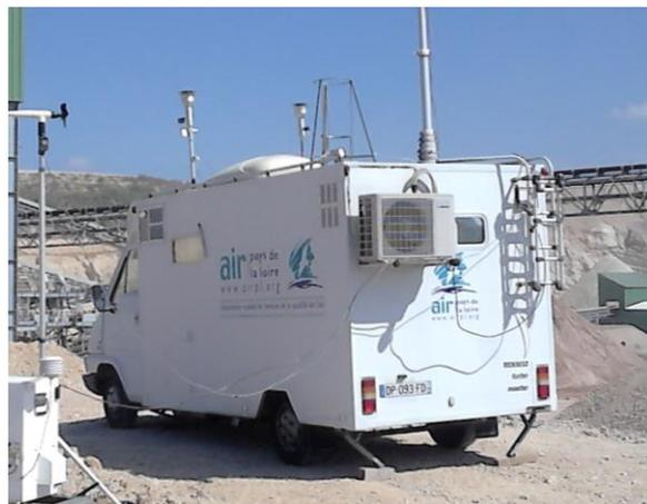
Figure 14 : Unité mobile installée sur le point carrière
