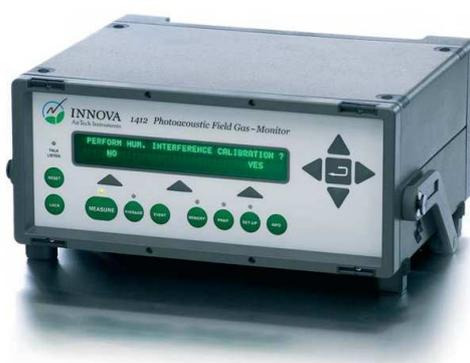
Figure 19 : Vue de l'analyseur multigaz INNOVA 1412
