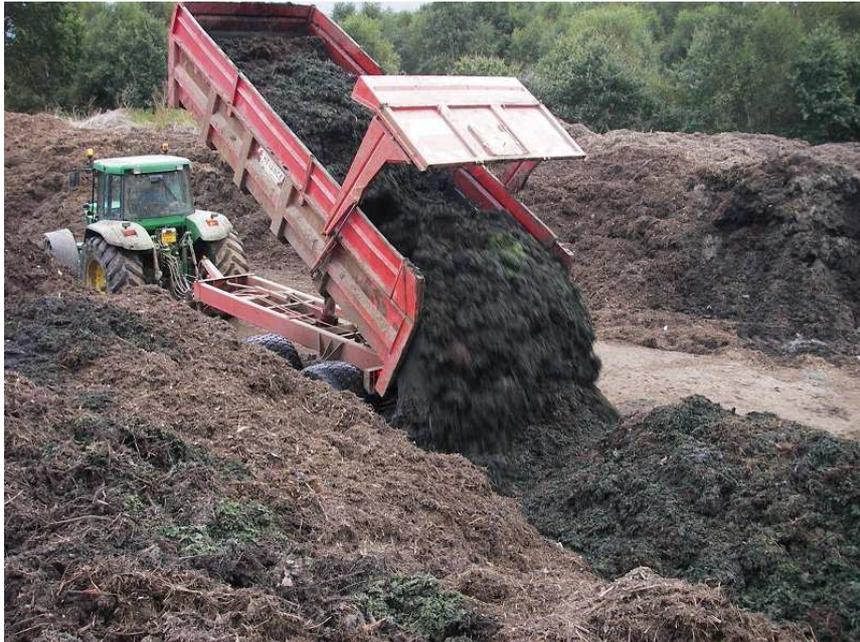
**Figure 14 : Déchargement des algues vertes avant reprise au chargeur. A droite de la remorque, le stock de broyat de déchets verts, à gauche l'andain sur lequel est mis en œuvre le mélange**
