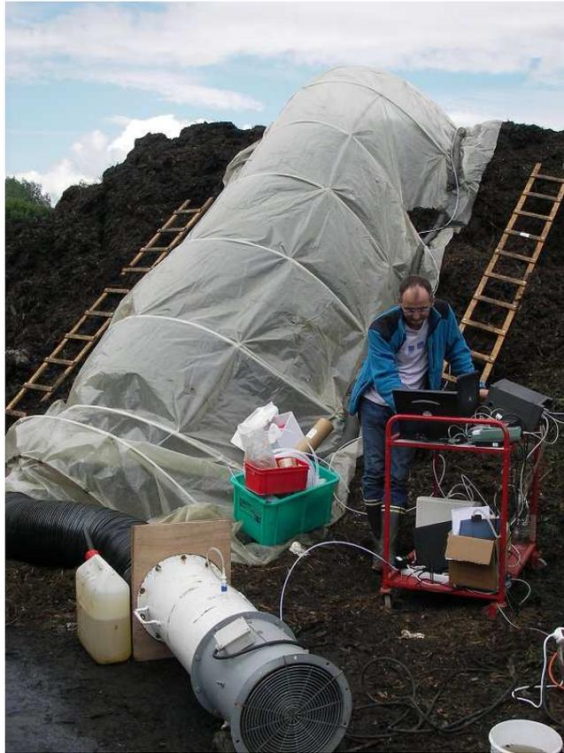
**Figure 17 : Vue d'ensemble du dispositif de mesure (emplacement 3) : tunnel, motoventilateur, chariot d'échantillonnage et d'analyse. L'entrée du tunnel est ici en haut de l'andain**
