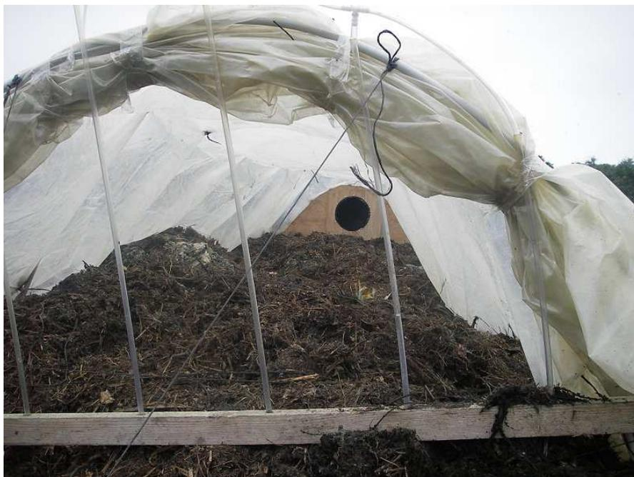
**Figure 18 : Vue de détail de l'entrée du tunnel (emplacement 2), munie des tubes percés d'échantillonnage de l'air**
