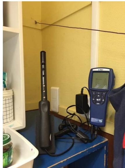
*Enregistrement en continu des concentrations en CO<sub>2</sub> au cours de la semaine de prélèvement dans la classe des PS/TPS*
