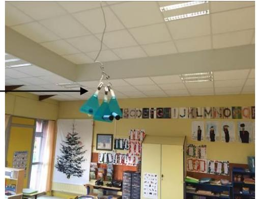
*Prélèvements par tubes passifs dans une salle de classe de Petite section/Moyenne section (PS/MS)*
