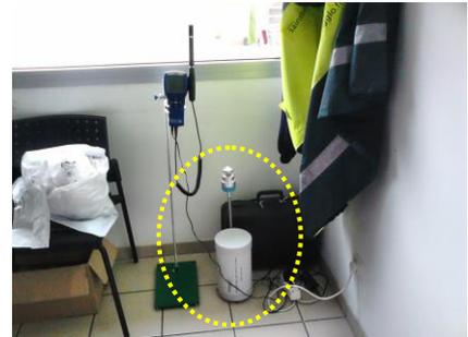
Figure 10 : Prélèvement de PM10 sur filtre pour analyse des métaux particulaires dans l'air intérieur
