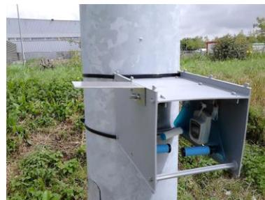
Figure 12 : Prélèvement par diffusion dans l'air extérieur (abri Radiello)
