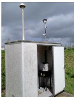
Figure 13 : Analyseur de particules disposé à proximité de la plateforme de compostage
