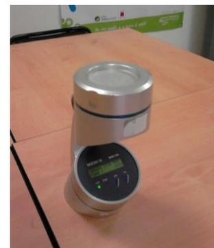
Figure 11 : Prélèvement de bactéries par impaction
