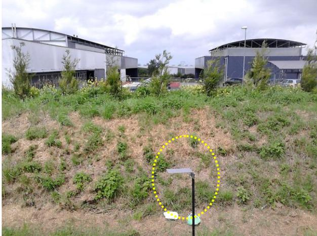
Les particules sédimentables ont été mesurées suivant la norme NFX 43-007 relative à la détermination de la masse des retombées atmosphériques sèches.
