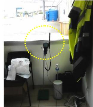
*Figure 8 : mesures du CO<sub>2</sub> et du taux de renouvellement dans l'air intérieur des locaux*
