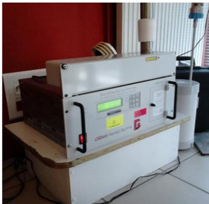
Un analyseur de particules a été mis en place dans l'une des pièces du bâtiment du centre technique permettant **le suivi en temps réel des concentrations en particules pour les fractions PM10\* et PM2.5\*** pendant une durée de 2 semaines.
