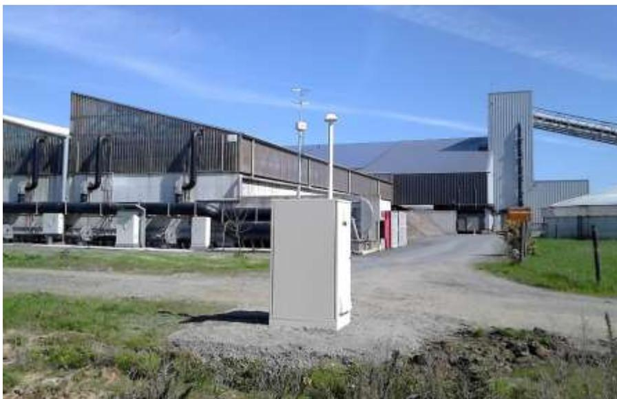
*Figure 11 : Site de mesure en continu de l'hydrogène sulfuré et des conditions météorologiques*
