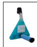
Fig. 1 : Prélèvements passif : tube à diffusion piégeant les polluants
