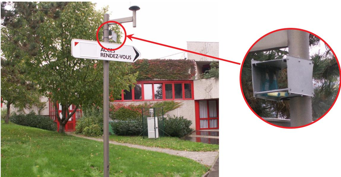
Fig.9 Dispositif de prélèvement des BTEX
