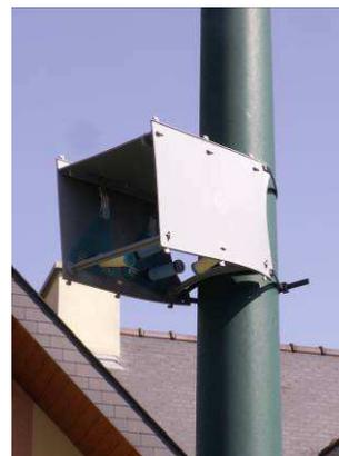
Les polluants sont ensuite récupérés par désorption thermique à 300°C environ, puis analysés par chromatographie en phase gazeuse. La concentration atmosphérique moyenne sur la période d'échantillonnage est ensuite calculée à partir de la masse piégée pendant l'exposition.
