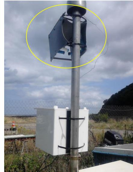
Figure 14 : Prélèvements par tubes passifs au niveau du chantier naval
