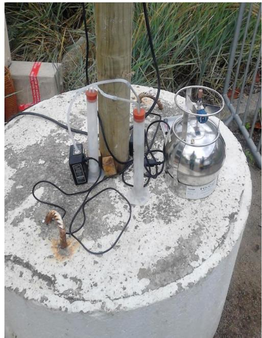
Figure 13 : Montage des prélèvements par canister et par barbotage
