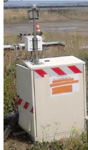
Figure 11: Cabine contenant l'analyseur H<sub>2</sub>S et SO<sub>2</sub>
