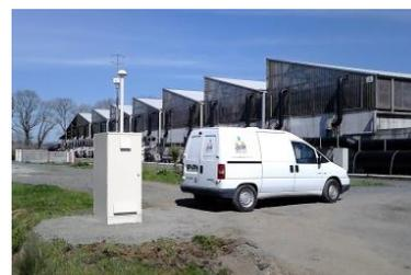
Figure 26 : Mesure d'hydrogène sulfuré à proximité d'une installation de traitement de déchets
