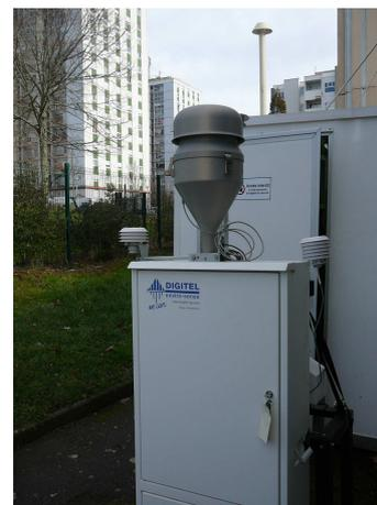
Des prélèvements journaliers de PM10 sont réalisés sur filtre, au moyen d'un préleveur haut débit (30m<sup>3</sup>/h environ), équipé d'une tête PM10.
